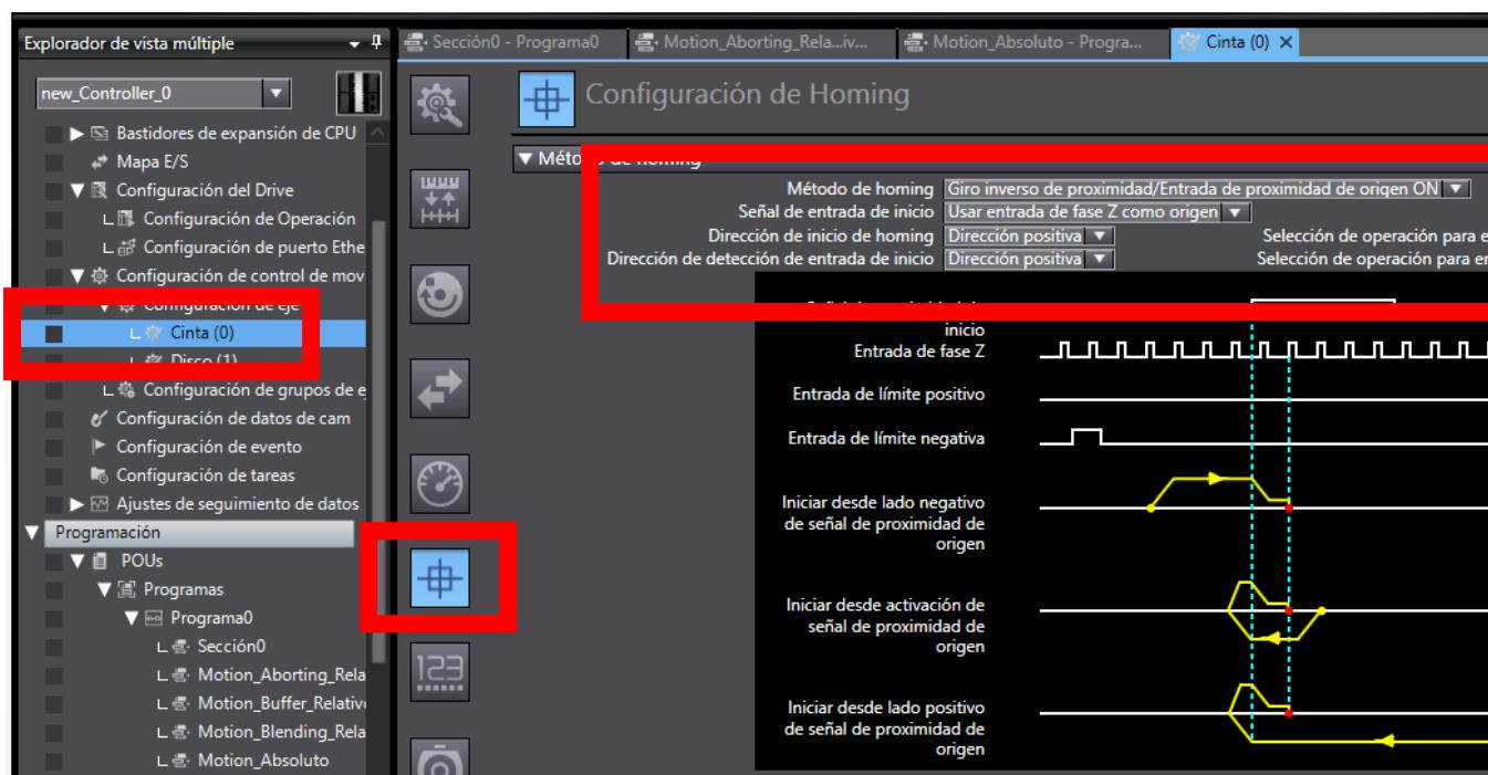
Para configurar el homing se toma como referencia la fase Z del encoder (1 pulso por vuelta), para tener más precisión.
