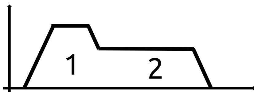
Cabe destacar que en movimiento eje a eje, el buffer es de 1 solamente. Por lo que si queremos concatenar más de dos movimientos a través de buffer, tenemos que usar las señales "Active". Vamos a mostrar un ejemplo de cómo se haría para concatenar 3 movimientos:
