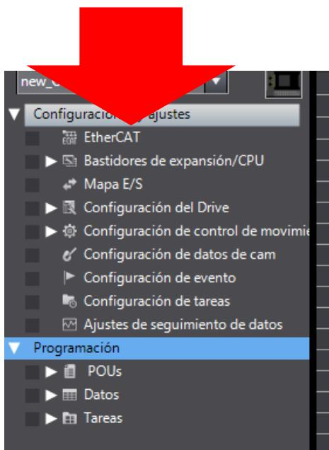
3. Configuramos Ethercat. Primero tendremos que poner físicamente el número de nodo en cada dispositivo que tengamos conectado. Ya sea una cabecera de E/S distribuida, un servo o un variador, tendremos que asignarle un número de nodo con unos interruptores rotatorios.
