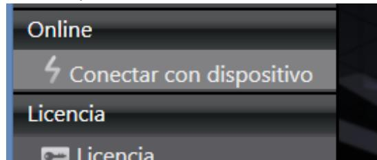
Debemos elegir si conectarnos por USB o por ETHERNET. Si nos conectamos por Ethernet recomendamos usar el tipo de conexión “HUB” y especificar la dirección IP. Si escogemos conexión directa por Ethernet nos ahorramos poner la IP pero a veces falla.
