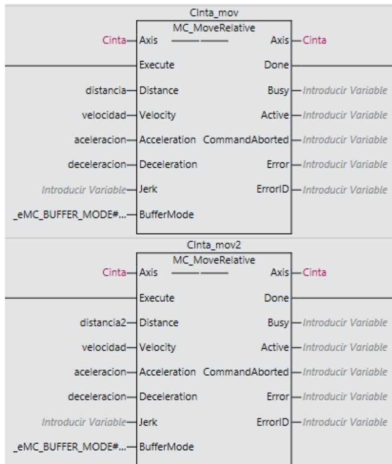
En este modo lo que ocurre es que si activamos los dos movimientos con el mismo trigger, se ejecuta primero el movimiento 1, y el movimiento 2 se guarda en buffer para ejecutarlo en cuanto termine el 1. Tal y como vemos en la siguiente imagen se ejecuta un movimiento y después otro:
