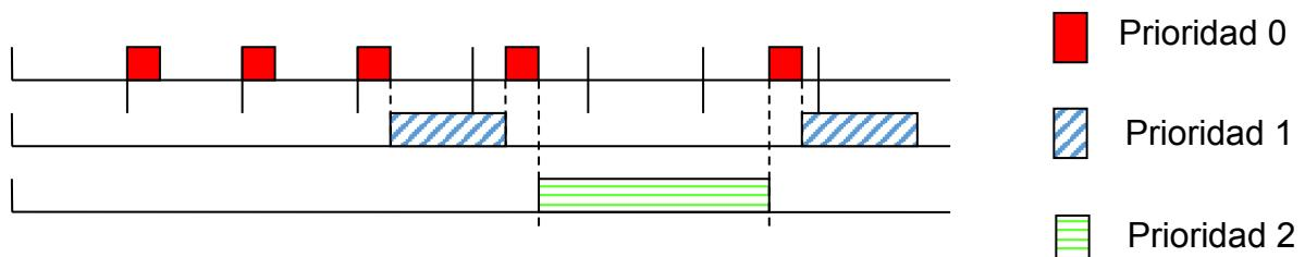
Este concepto de alternar tareas permite ejecuciones en tiempo real y es necesario para aplicaciones de Motion, donde es fundamental la rapidez para tener precisión. Esto permite asignar tareas de 1ms prioritarias en donde en ese intervalo leemos la posición del encoder y se ejecuta el envío de la información por EtherCAT.
