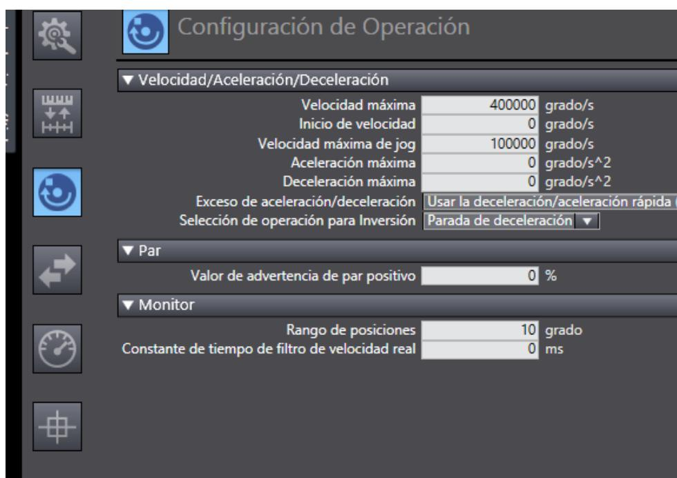
4. Comprobación de funcionamiento. Nos situamos encima del servo, botón derecho → "Iniciar prueba de funcionamiento MC".
