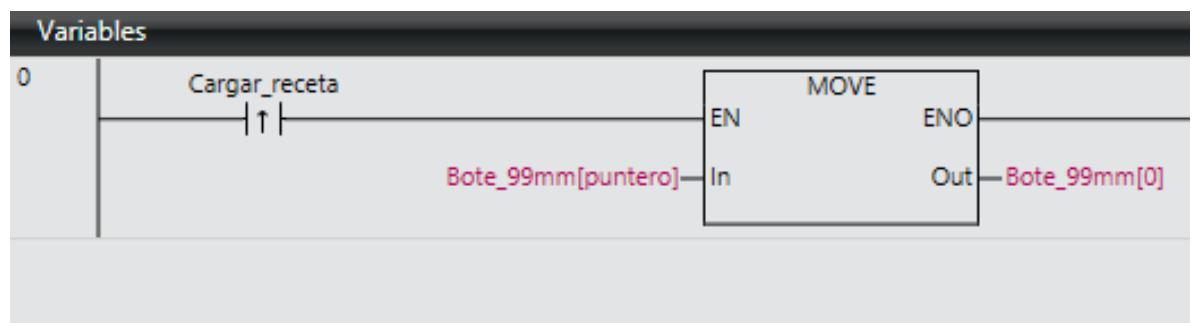
Así cuando queramos cargar una nueva receta nueva, sólo tendremos que cambiar el valor de “puntero” en el HMI. Y después activamos el bit “Cargar\_receta”. De esta manera tan simple haríamos el cambio de receta/formato.
